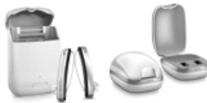
Зарядные устройства заряжают слуховые аппараты, и вам нет необходимости беспокоиться об аккумуляторах. Совместимое со слуховыми аппаратами Pure Charge&Go Nx, Motion Charge&Go Nx индукционное зарядное устройство второго поколения помогает зарядить и высушить слуховой аппарат, чтобы пользователь мог использовать его в течение всего дня.
